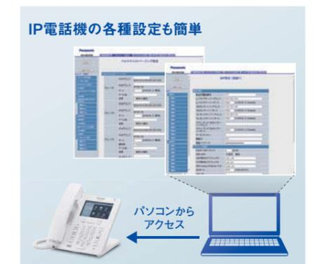
KX-HDVシリーズは、Webサーバー機能を内蔵しています。ブラウザを利用してネットワーク上のパソコンからIP電話機にアクセスし、リモートで機器情報やネットワークなどの設定を簡単に行うことができます。
