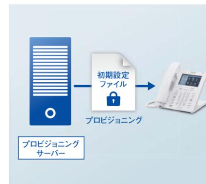
ネットワークに電話機を接続すると、プロビジョニングサーバーから初期設定ファイルがダウンロードされ、端末の設定を自動的に行います。※2
